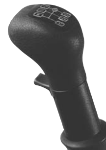
Рис. 2а ZF схема переключения каскадное Н и рычаг переключения передач
